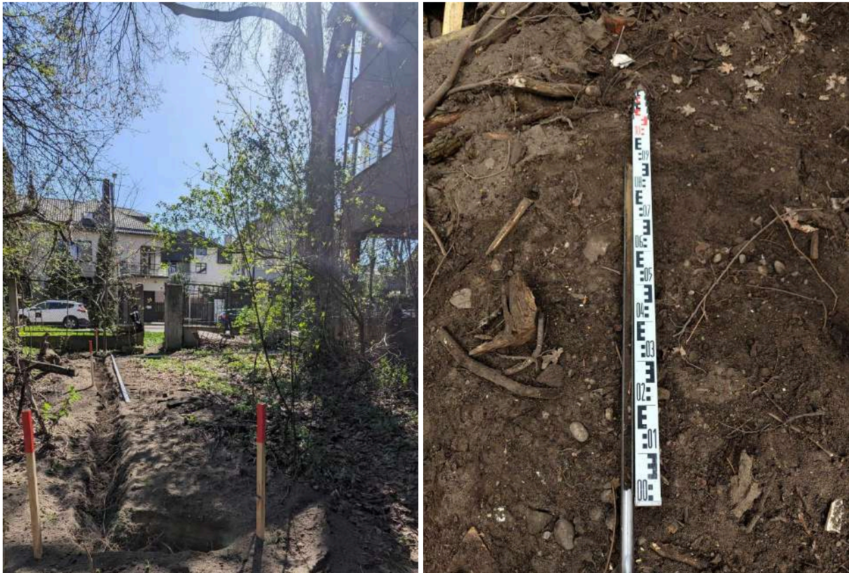
Pav. 4.2.3. Paprastosios vinkšnos augavietė Latvių g. 9 sklypo pietvakarinėje dalyje. Grunto ėminys rodo humusingą priemolio ir priemolio mišinį.
