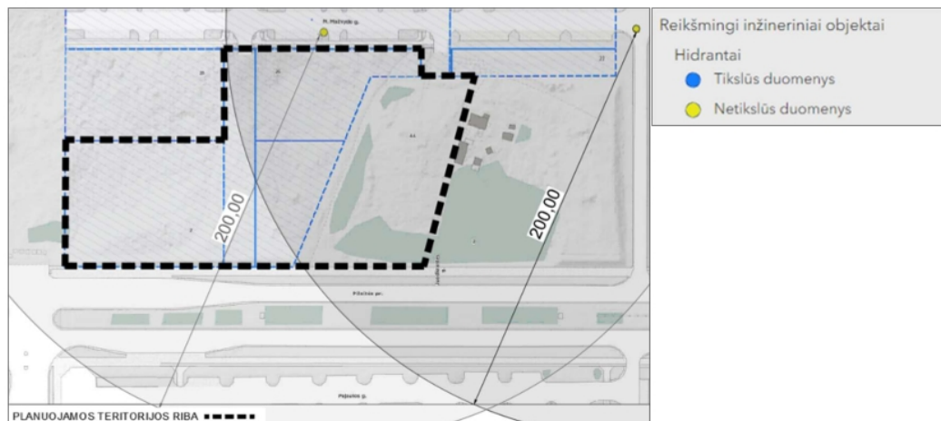
19 pav. Išorės gaisro gesinimo schema
