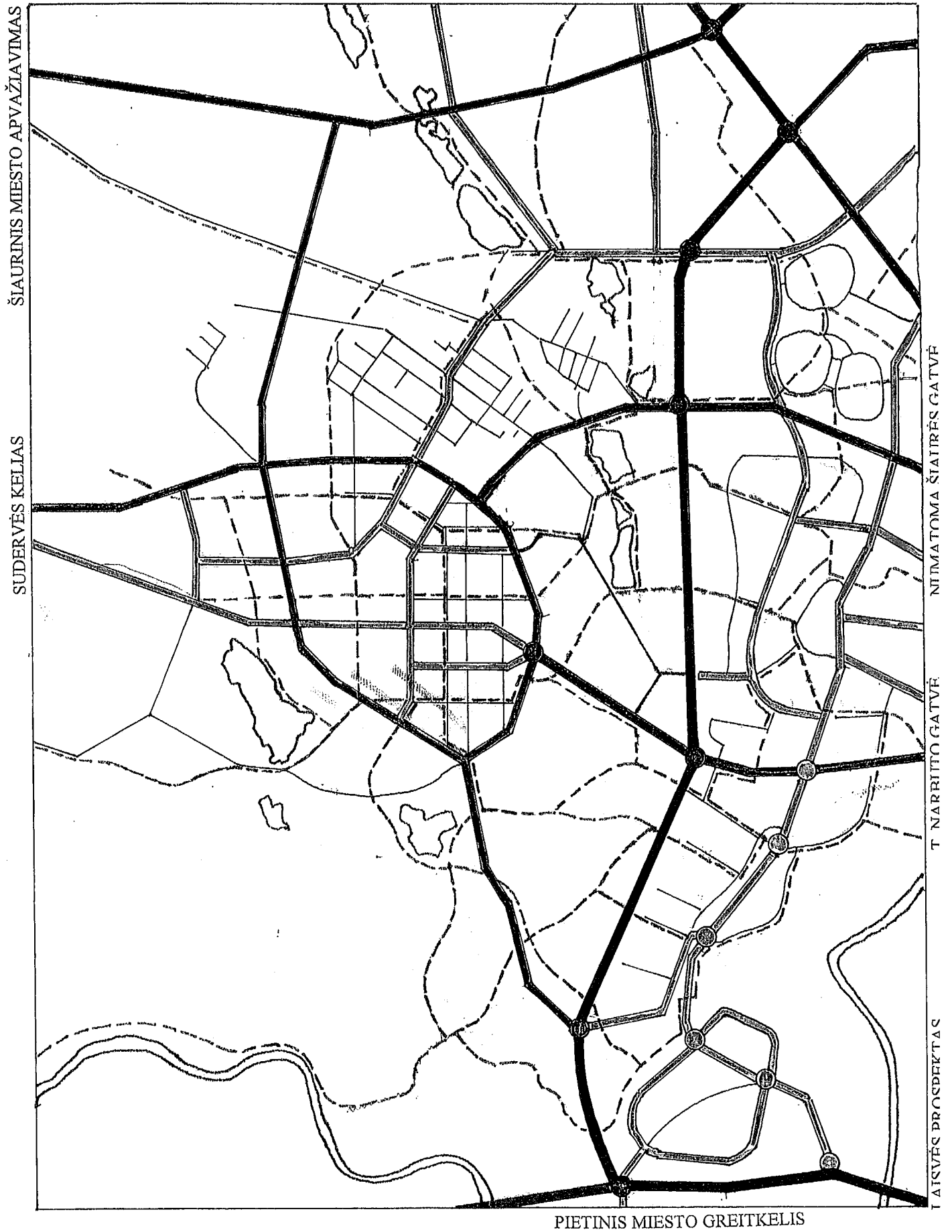
1 schema. Planuojamas Pilaitės šiaurinio rajono susisiekimo tinklas Vilniaus miesto vakarinės teritorijos transporto sistemoje.
