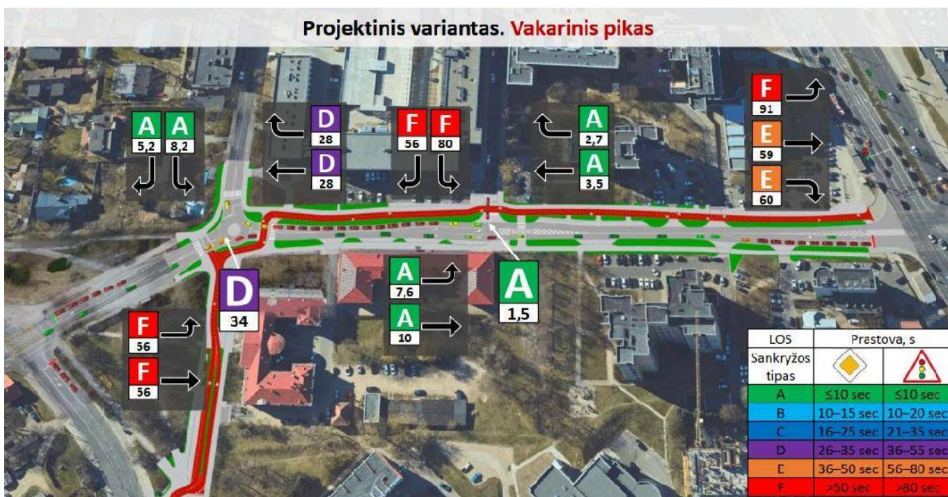
19 pav. Ištrauka iš MB „Eismo inžinerija“ gatvės eismo srautų modeliavimo ataskaitos (Projektinės situacijos modeliavimas vakarinio piko metu)
