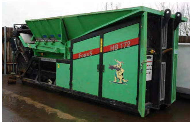
HB 172 mit eingeklapptem Förderband
