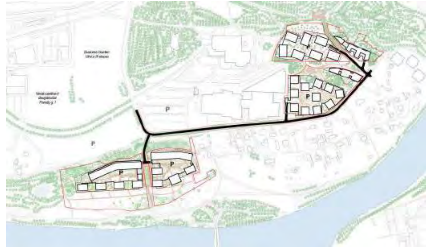
Automobilių srautai. Automobilių atvažiavimo į sklypus schema, požeminių automobilių stovėjimo vietų lokacijos
