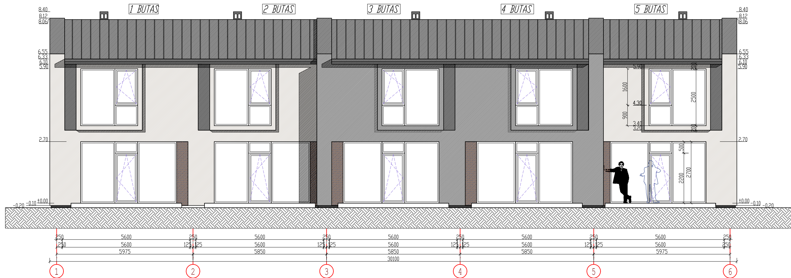
FASADAS TARP AŠIŲ 1-6 M 1:100
