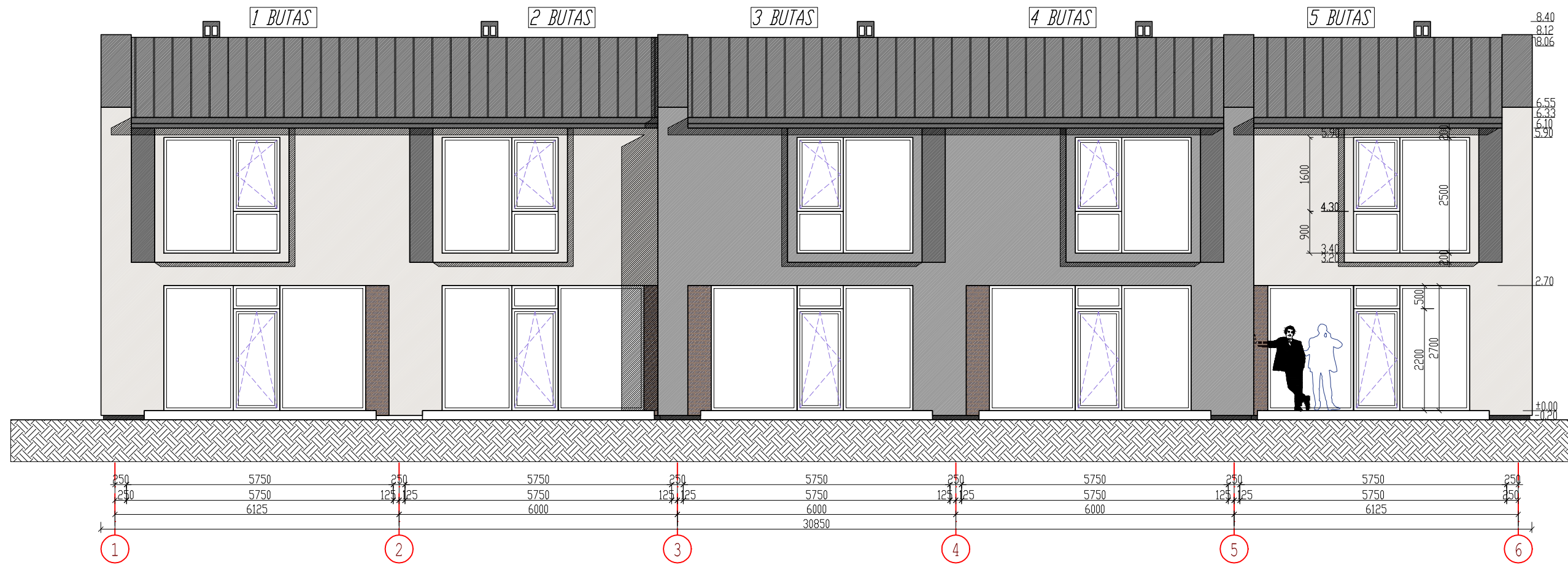
FASADAS TARP AŠIŲ 1-6 M 1:100
