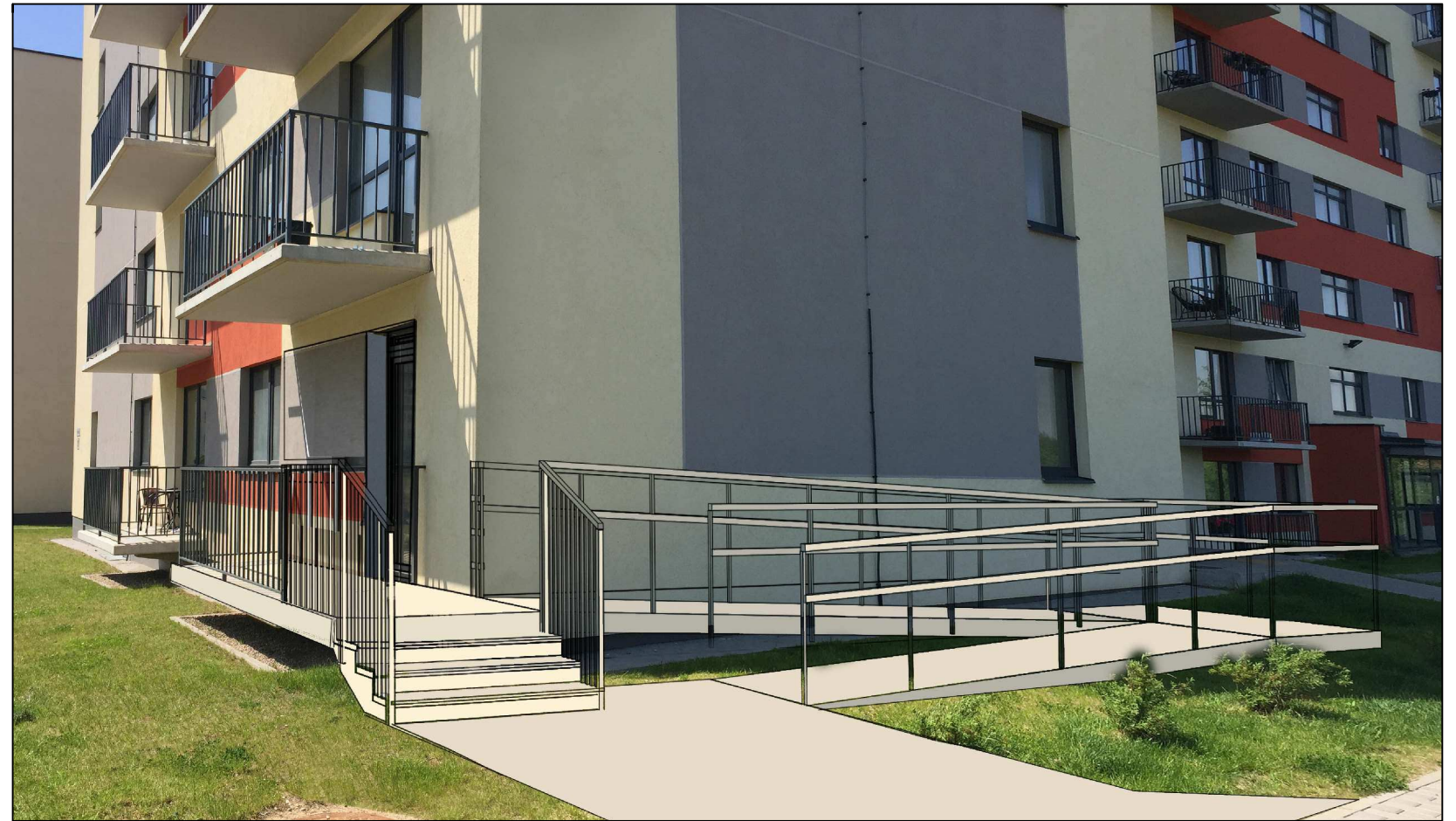
Projektuojamas tiesioginis įėjimas iš lauko su lengvųjų konstrukcijų pandusu žmonių su negalia judėjimui
