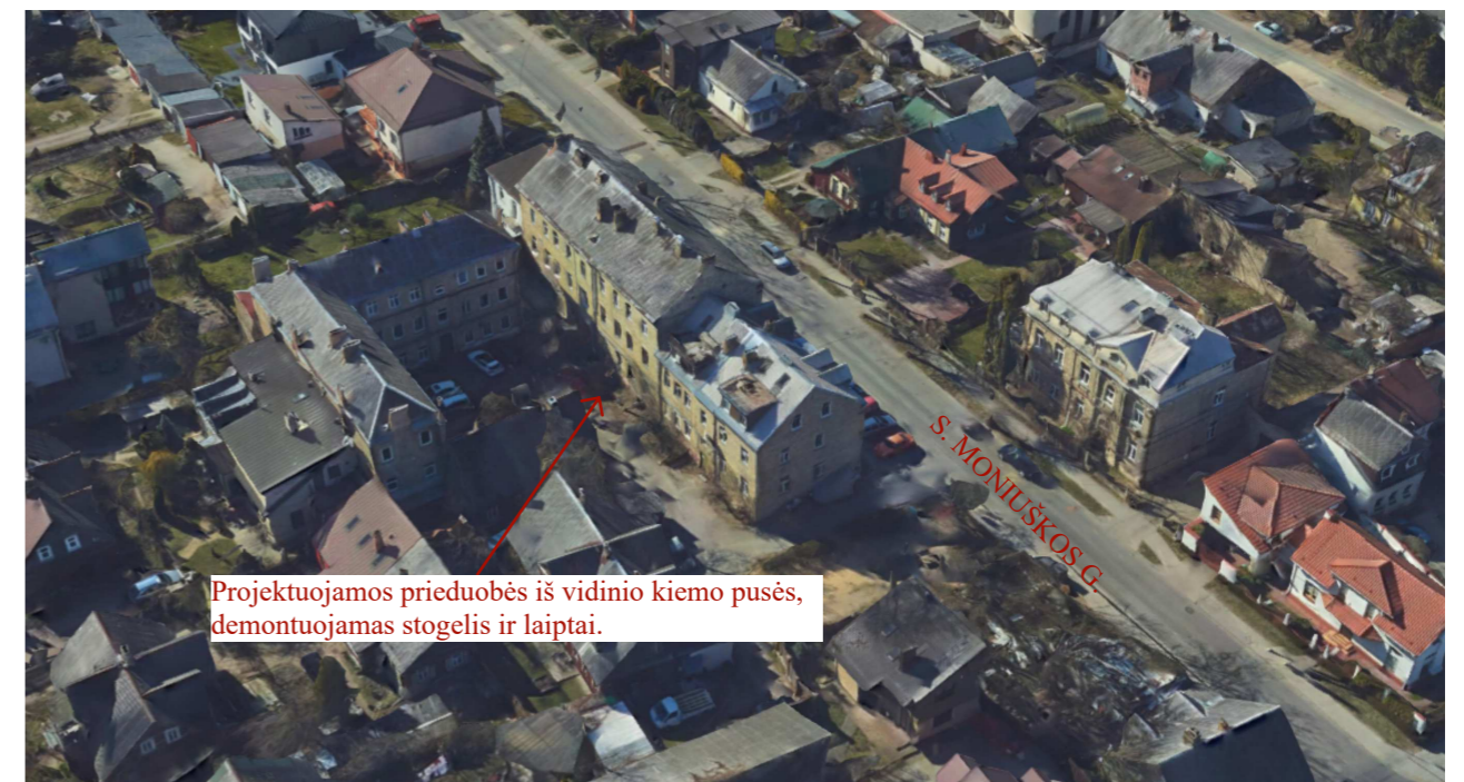
Patalpos (unik. Nr. 1094-0336-8010:0036) dalis, kurios demontuojamas stogelis ir laiptai, užtaisant įėjimo angą, paliekant prieduobę.
