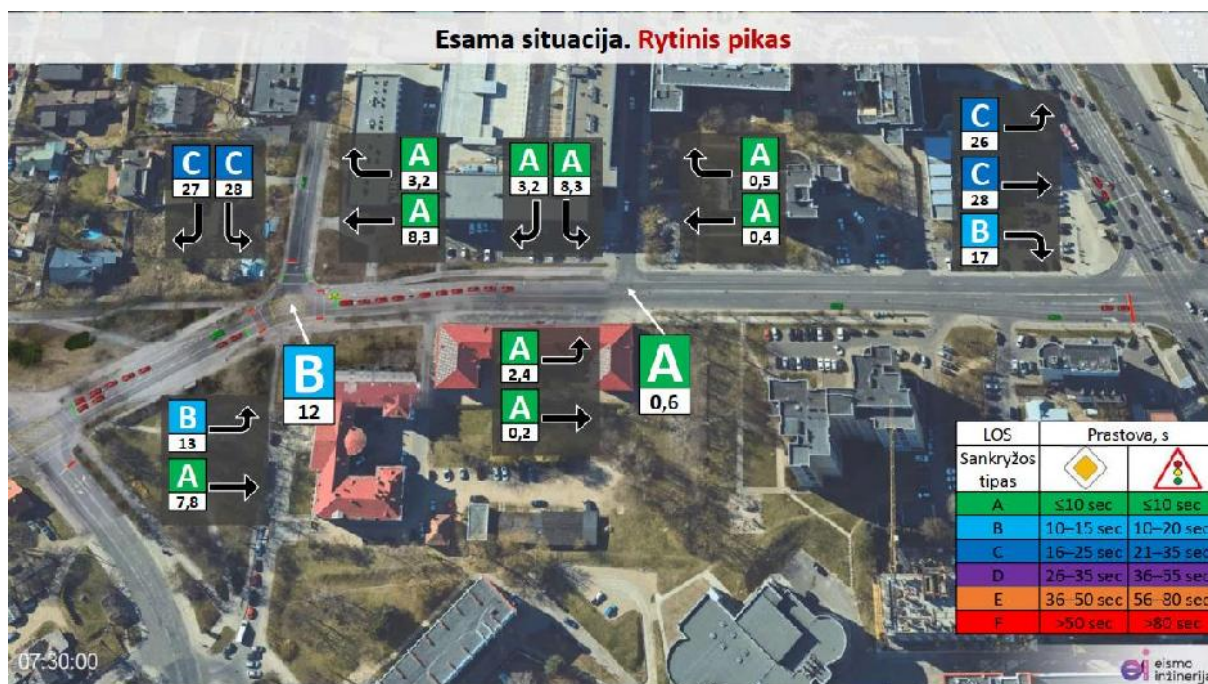
16 pav. Ištrauka iš MB „Eismo inžinerija“ gatvės eismo srautų modeliavimo ataskaitos (Esamos situacijos modeliavimas rytinio piko metu)
