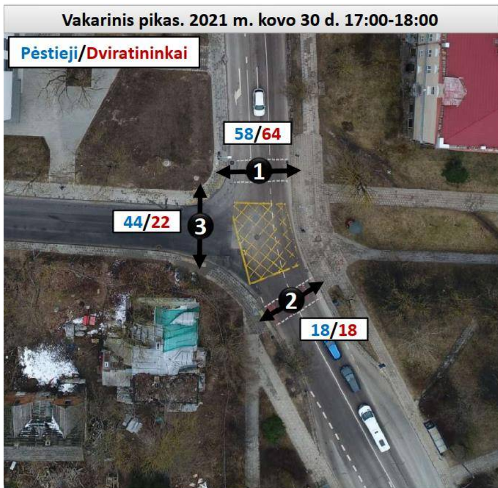
15 pav. Ištrauka iš MB „Eismo inžinerija“ gatvės eismo srautų modeliavimo ataskaitos (Eismo srautai pėsčiųjų ir dviračių srautai vakarinio piko metu Saltoniškių – Sėlių gatvių sankirta)
