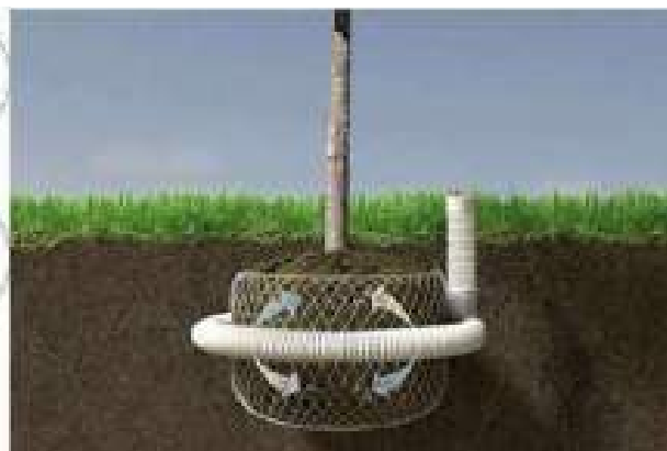
Pav.4 Principinė aeravimo sistemos schema
