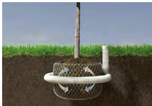
Pav.2 Principinė aeravimo sistemos schema
