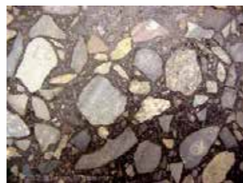
Pėsčiųjų takas ant tilto. Pigmentuotas asfaltas su granito skalda [Šlifluotas]
