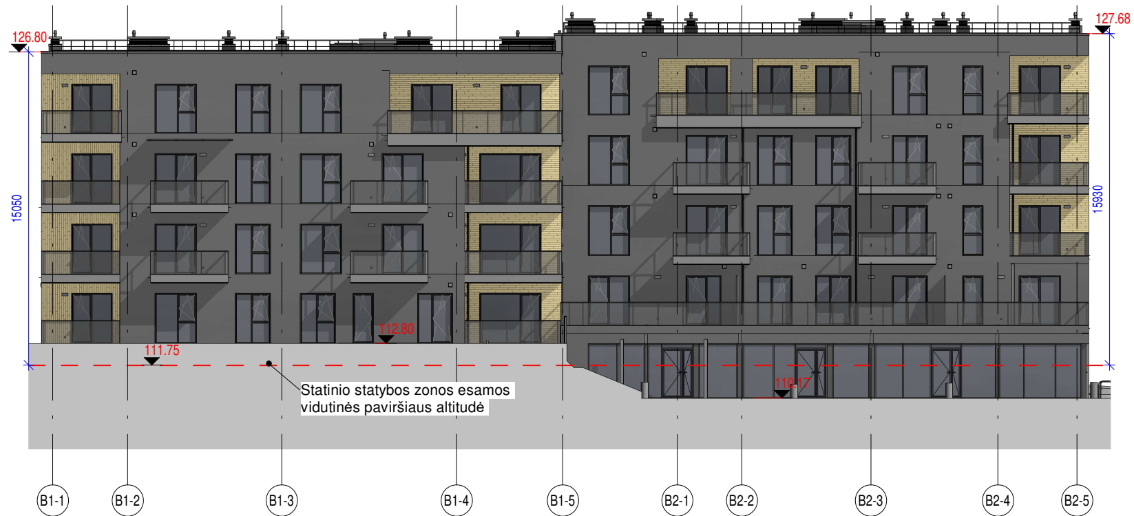
Fasadas tarp ašiu B1-1 ir B2-5 M1 : 250
