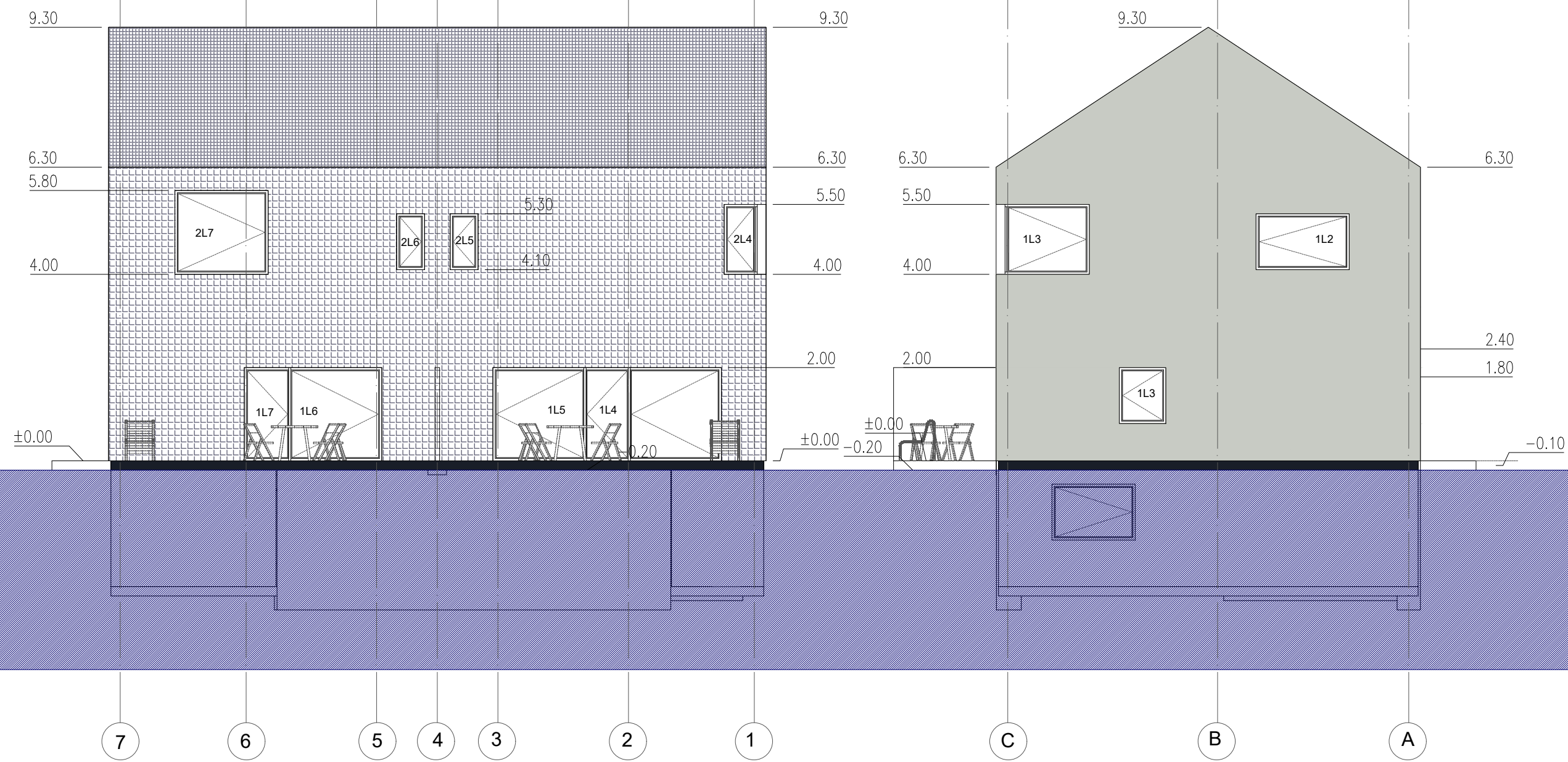
FASADAS TARP AŠIŲ 7-1 M 1:100
