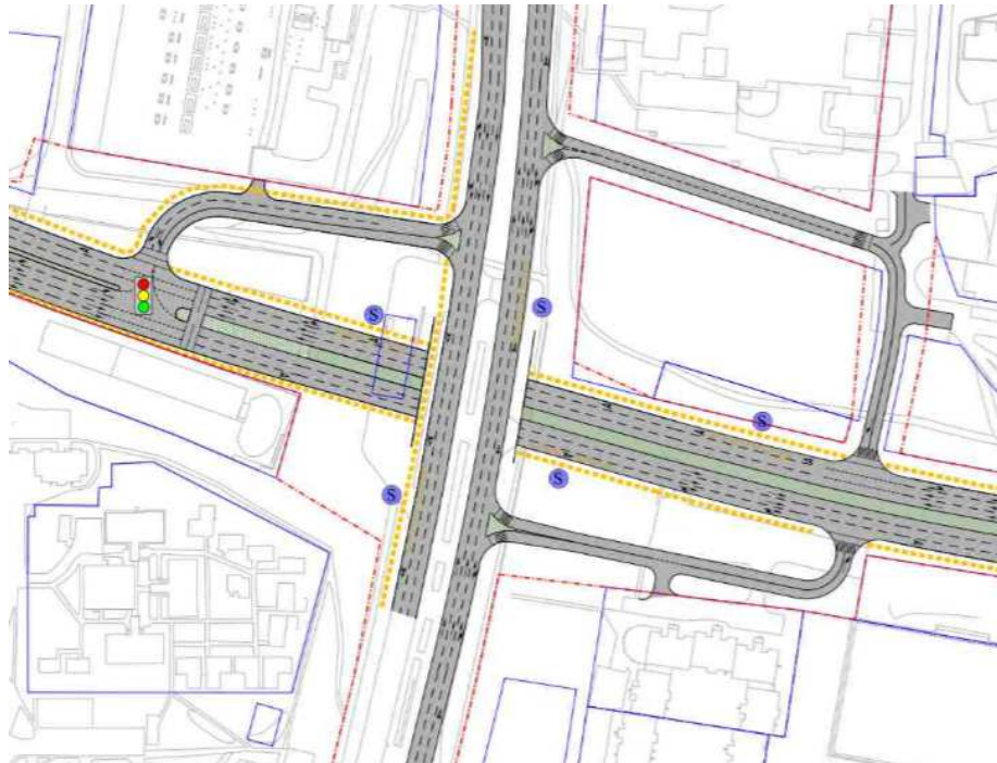
3.4 pav. Šiaurinės–Laisvės pr. skirtingų lygių sankryža
