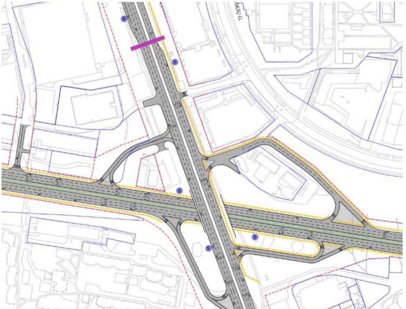
3.6 pav. Šiaurinės–Ukmergės g. skirtingų lygių sankryža
