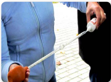
6.3 pav. Pataisų sporų degumo ore tyrimas: sporos talpinamos į pipetę ir, spaudžiant guminę kriaušę, pučiamos į degiklio įžiebtą ugnį
