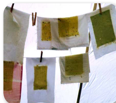
6.4 pav. Popieriaus gamyba: A, B – talpa su popieriaus masės tirpalu (gali būti dumblių, plūdenų masė), popieriaus masė iš tirpalo iškeliama tinkleliu, pritvirtintu prie rėmo; C, D, E – tinklėlis su popieriaus mase paliekamas vandeniui nutekėti, ruošiamas džiovinti; F, G – ant tinklėlio padarytas raštas atsispaus popieriuje (taip gaunami popieriuje vandens ženklai); H, I – nuo tinklėlio nukeltas šlapias popieriaus lakštas talpinamas ant drobės ar kito paviršiaus ir džiovinamas, prieš džiovinant popierius gali būti puošiamas augalų detalėmis, kvėpinamas, pridedant kvapiųjų medžiagų
