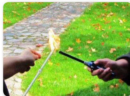
6.3 pav. Pataisų sporų degumo ore tyrimas: sporos talpinamos į pipetę ir, spaudžiant guminę kriaušę, pučiamos į degiklio įžiebtą ugnį
