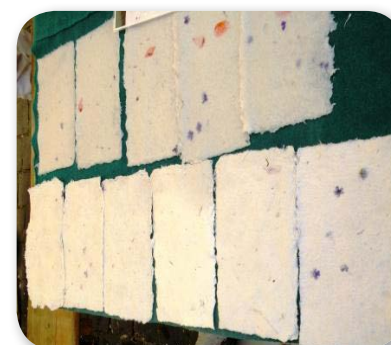
6.4 pav. Popieriaus gamyba: A, B – talpa su popieriaus masės tirpalu (gali būti dumblių, plūdenų masė), popieriaus masė iš tirpalo iškeliama tinkleliu, pritvirtintu prie rėmo; C, D, E – tinklėlis su popieriaus mase paliekamas vandeniui nutekėti, ruošiamas džiovinti; F, G – ant tinklėlio padarytas raštas atsispaus popieriuje (taip gaunami popieriuje vandens ženklai); H, I – nuo tinklėlio nukeltas šlapias popieriaus lakštas talpinamas ant drobės ar kito paviršiaus ir džiovinamas, prieš džiovinant popierius gali būti puošiamas augalų detalėmis, kvėpinamas, pridedant kvapiųjų medžiagų
