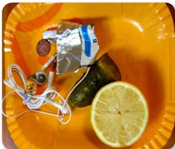
7.1 pav. Galvaninio elemento modelio gamybai reikalingos priemonės ir pagamintas modelis
