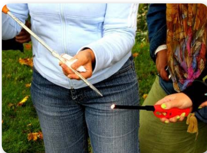
6.3 pav. Pataisų sporų degumo ore tyrimas: sporos talpinamos į pipetę ir, spaudžiant guminę kriaušę, pučiamos į degiklio įžiebtą ugnį
