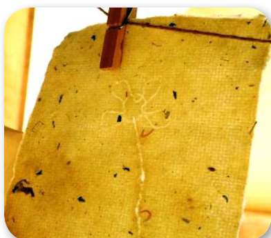
6.4 pav. Popieriaus gamyba: A, B – talpa su popieriaus masės tirpalu (gali būti dumblių, plūdenų masė), popieriaus masė iš tirpalo iškeliama tinkleliu, pritvirtintu prie rėmo; C, D, E – tinklėlis su popieriaus mase paliekamas vandeniui nutekėti, ruošiamas džiovinti; F, G – ant tinklėlio padarytas raštas atsispaus popieriuje (taip gaunami popieriuje vandens ženklai); H, I – nuo tinklėlio nukeltas šlapias popieriaus lakštas talpinamas ant drobės ar kito paviršiaus ir džiovinamas, prieš džiovinant popierius gali būti puošiamas augalų detalėmis, kvėpinamas, pridedant kvapiųjų medžiagų
