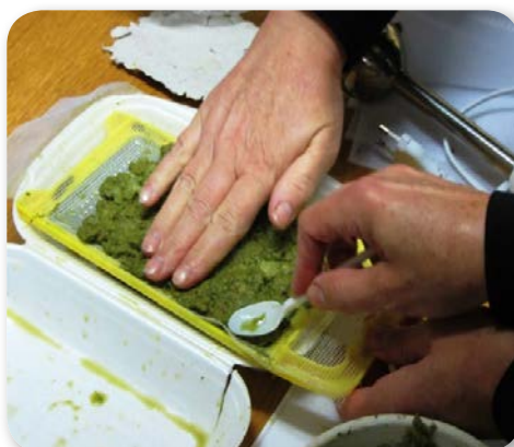
6.1 pav. Popieriaus gamyba: A – žaliava popieriaus gamybai: plūdenos ir žalieji dumbliai, B – žaliavos susmulkinimas, popieriaus masės ruošimas džiovinti
