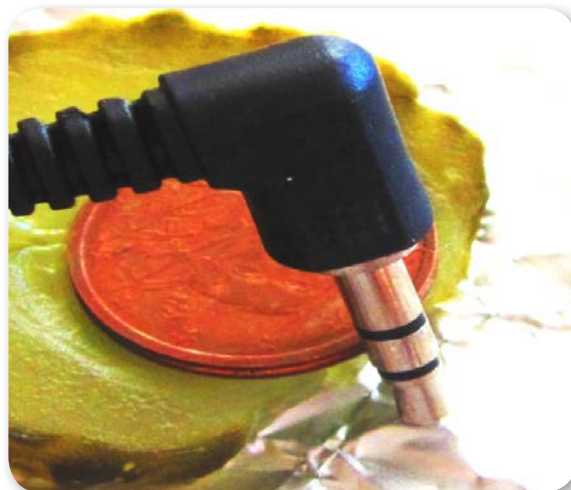
7.1 pav. Galvaninio elemento modelio gamybai reikalingos priemonės ir pagamintas modelis
