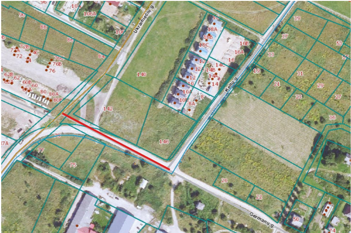
8 pav. Projektuojamos Germanų gatvės atkarpa ir esamos Germanų gatvės trajektorija (pažymėta projektuojama atkarpa nuo žemės sklypo (kadastro Nr. 0101/0158:2130) iki Germanų gatvės). regia.lt žemėlapis fragmentas.
