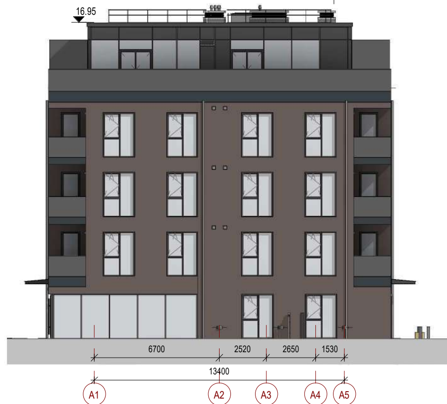
Fasadas tarp ašių A1 ir A5 M 1 : 200
