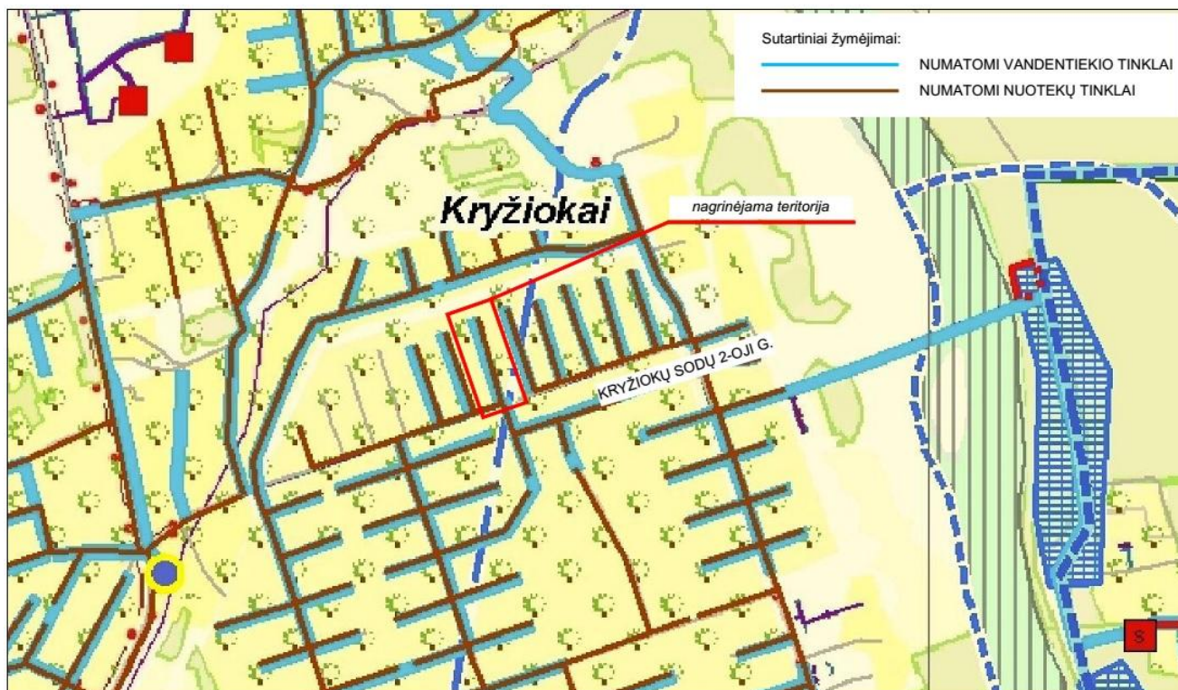
1 pav. Numatomi vandentiekio ir nuotekų tinklai Kryžiokų sodų teritorijoje (ištrauka iš specialaus plano)
