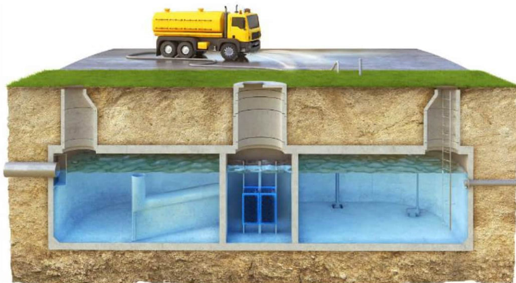
4.8 pav. Uždaros paviršinių nuotekų kaupyklos schema (Šaltinis: https://prespa.lt/daugiafunkciniai-rezervuarai-hydrozone-2/ )
