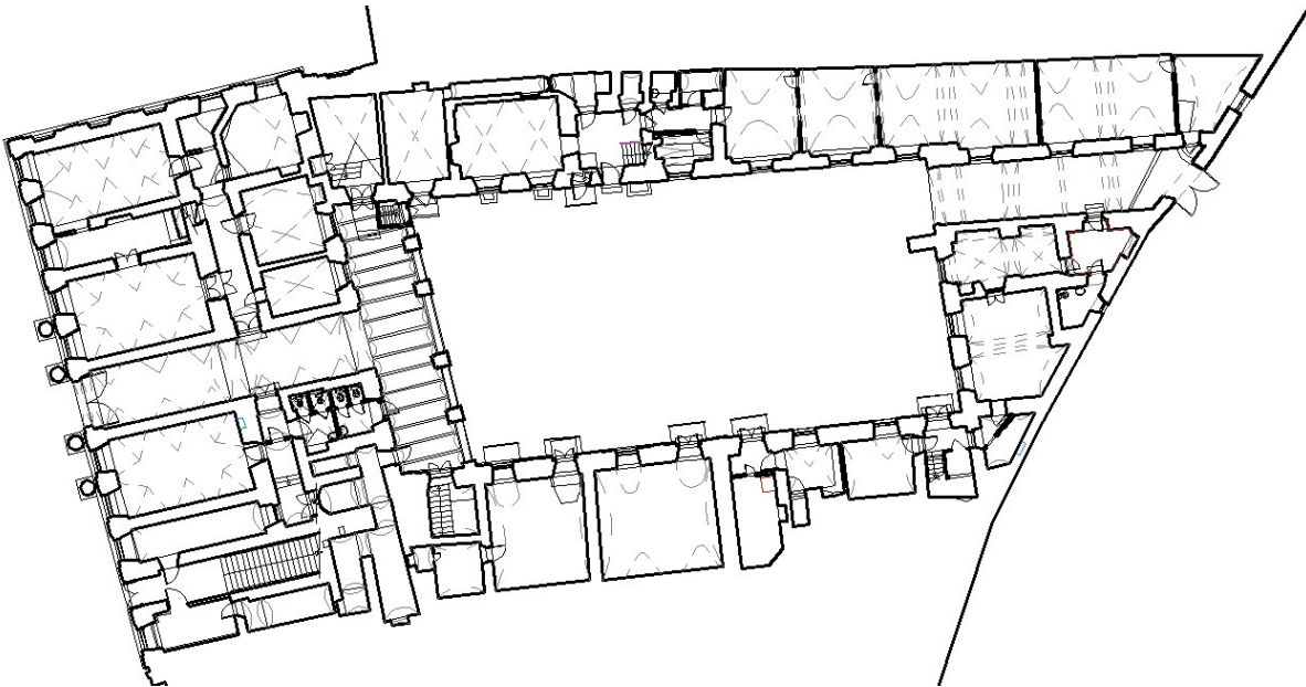
Pirmo aukšto planas. Fotogrametrinių apmatavimų medžiaga. Punktyru pažymėti pirmo aukšto denginio skliautai
