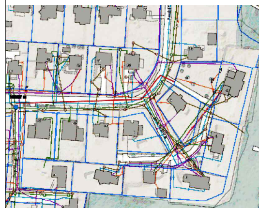
Priešgaisrinio vandens paėmimo schema: Priešgaisrinis vanduo imamas iš hidranto esančio 14,3m iki projektuojamo namo
