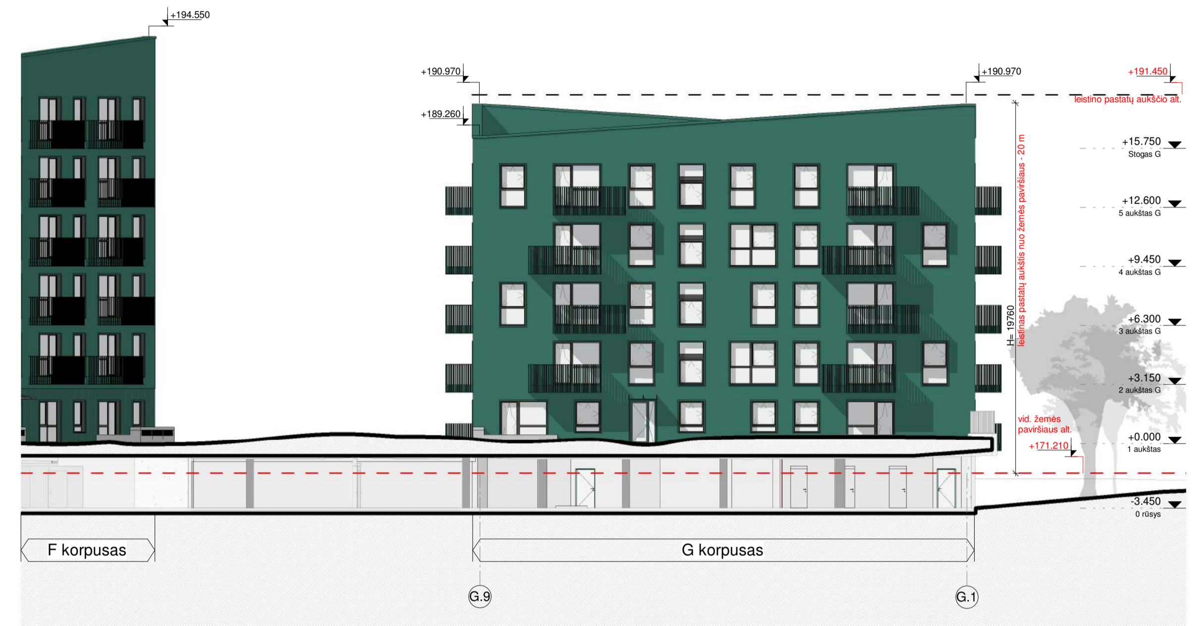
2. FASADAS TARP AŠIŲ G.9 - G.1 (Kiemo fasadas) 1 : 200
