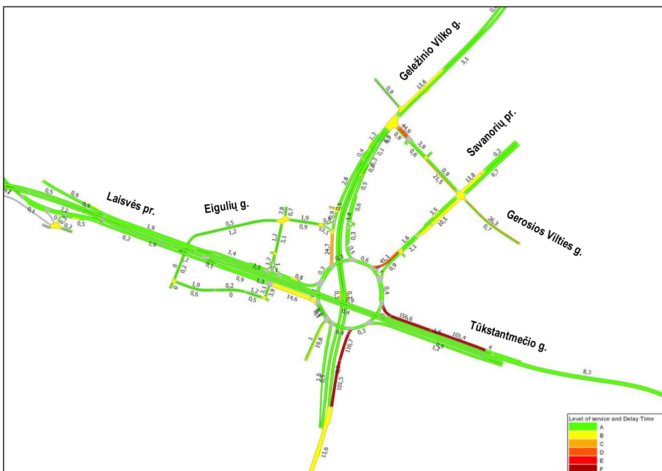
3.3 pav. „ESAMA situacija“ Transporto srautų eismo kokybės lygio vidurkis vakarinio piko metu.
