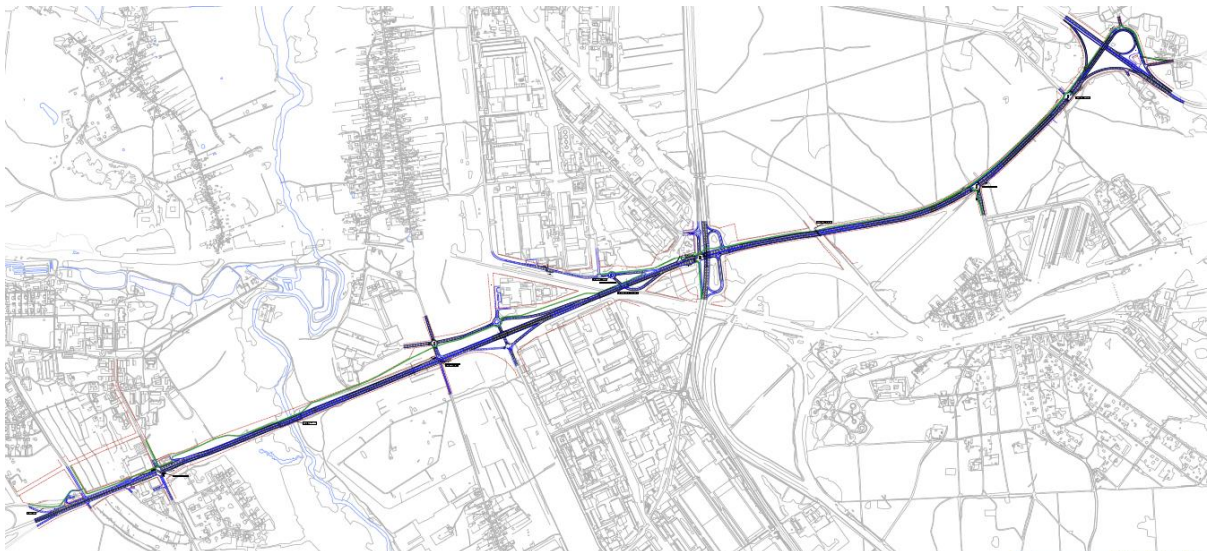
3 pav. II koncepcijos variantas. Galvės g. rekonstrukcijos su magistraliniu dviračių taku trasos plano projektiniai sprendiniai
