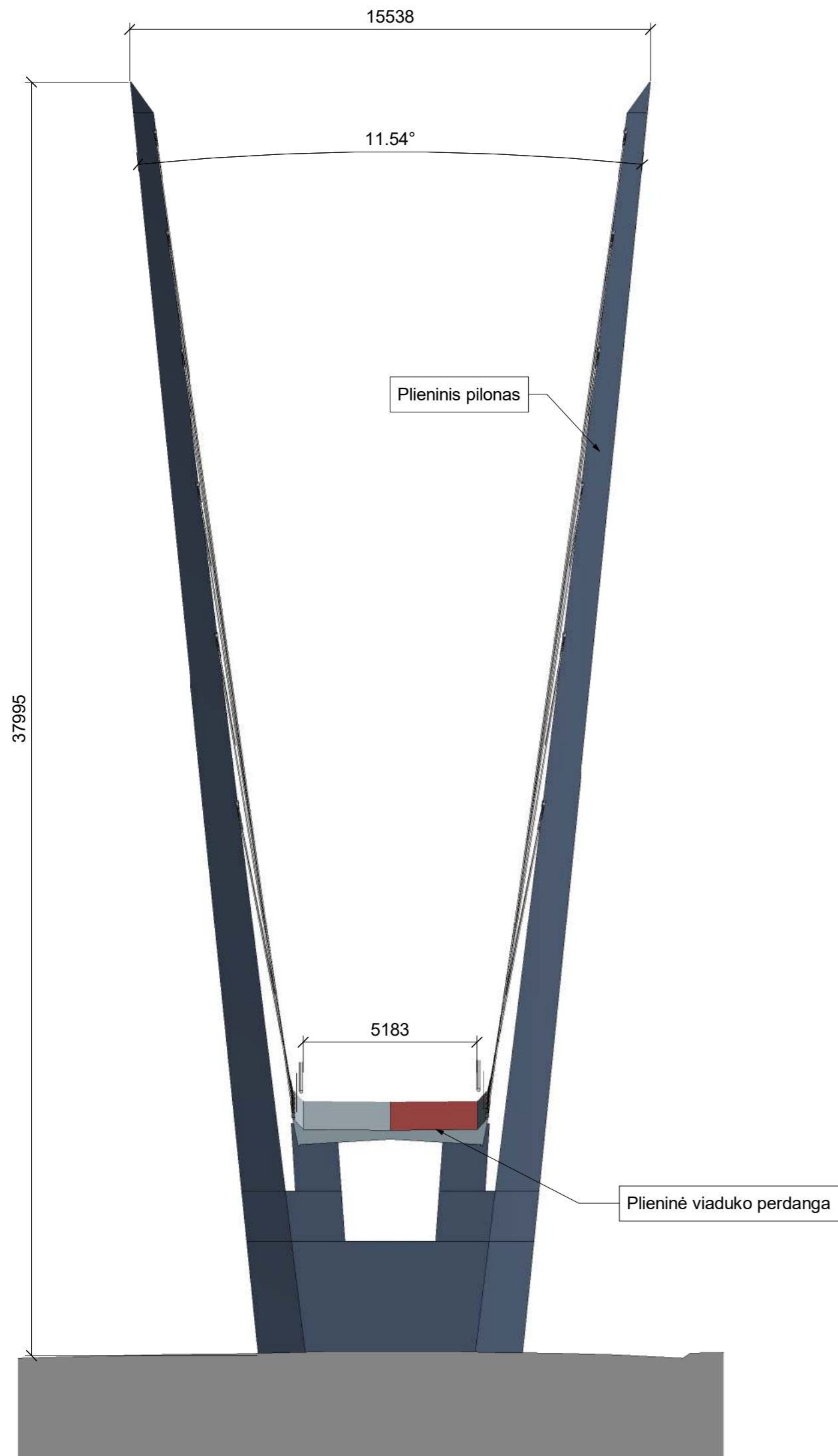
Pėsčiųjų viaduko skersinis pjūvis 4-4 M1 : 150
