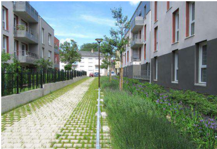
21-22 pav. Mišrios pėsčiųjų tako dangos analogas: dalis tako įrengiama naudojant betonines trinkeles, dalis tako pakraščių įrengiami naudojant drenuojančio tipo ažūrinės trinkeles, tarpus užsėjant žole
