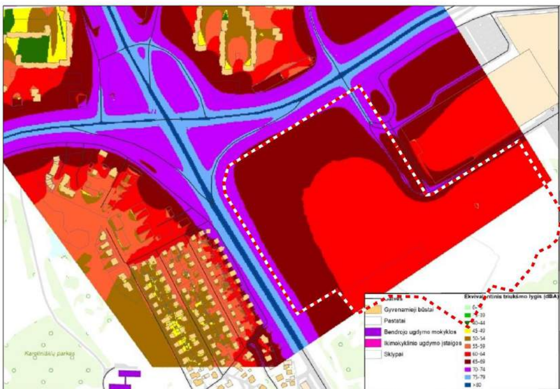
14 pav. Esamos situacijos Lv triukšmo lygis (4 m aukštyje) gyvenamųjų ir visuomeninės paskirties pastatų aplinkoje nuo autotransporto srauto (didžiausias leidžiamas triukšmo ribinis dydis – 60 dBA)
