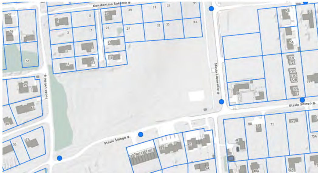
1 pav. Esami hidrantai gaisrų gesinimui aplink pastatą
