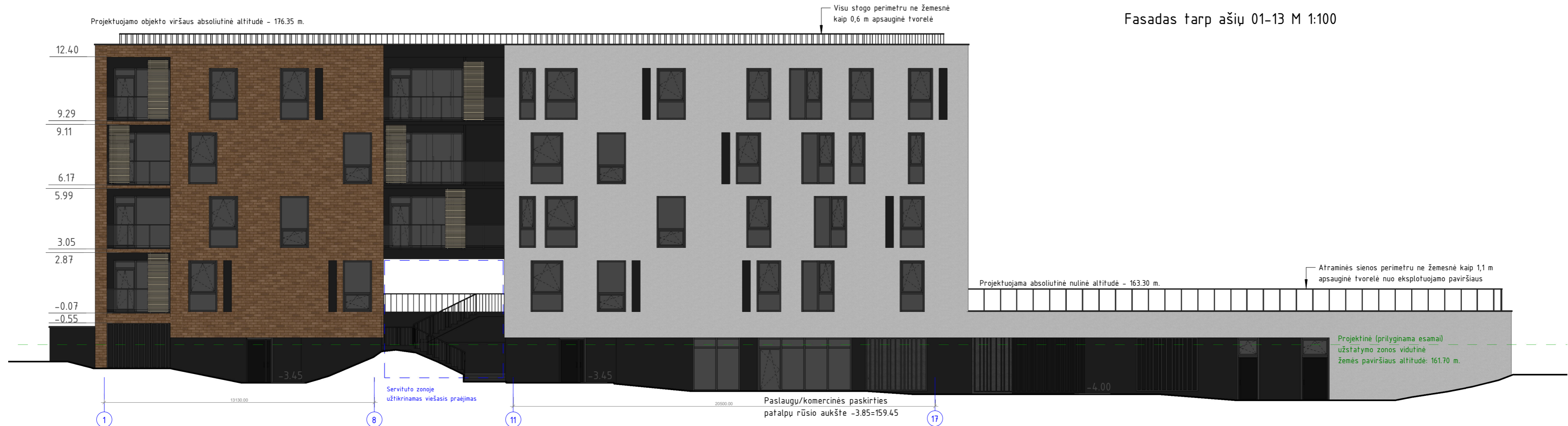
Fasadas tarp ašiu A-M M 1:100
