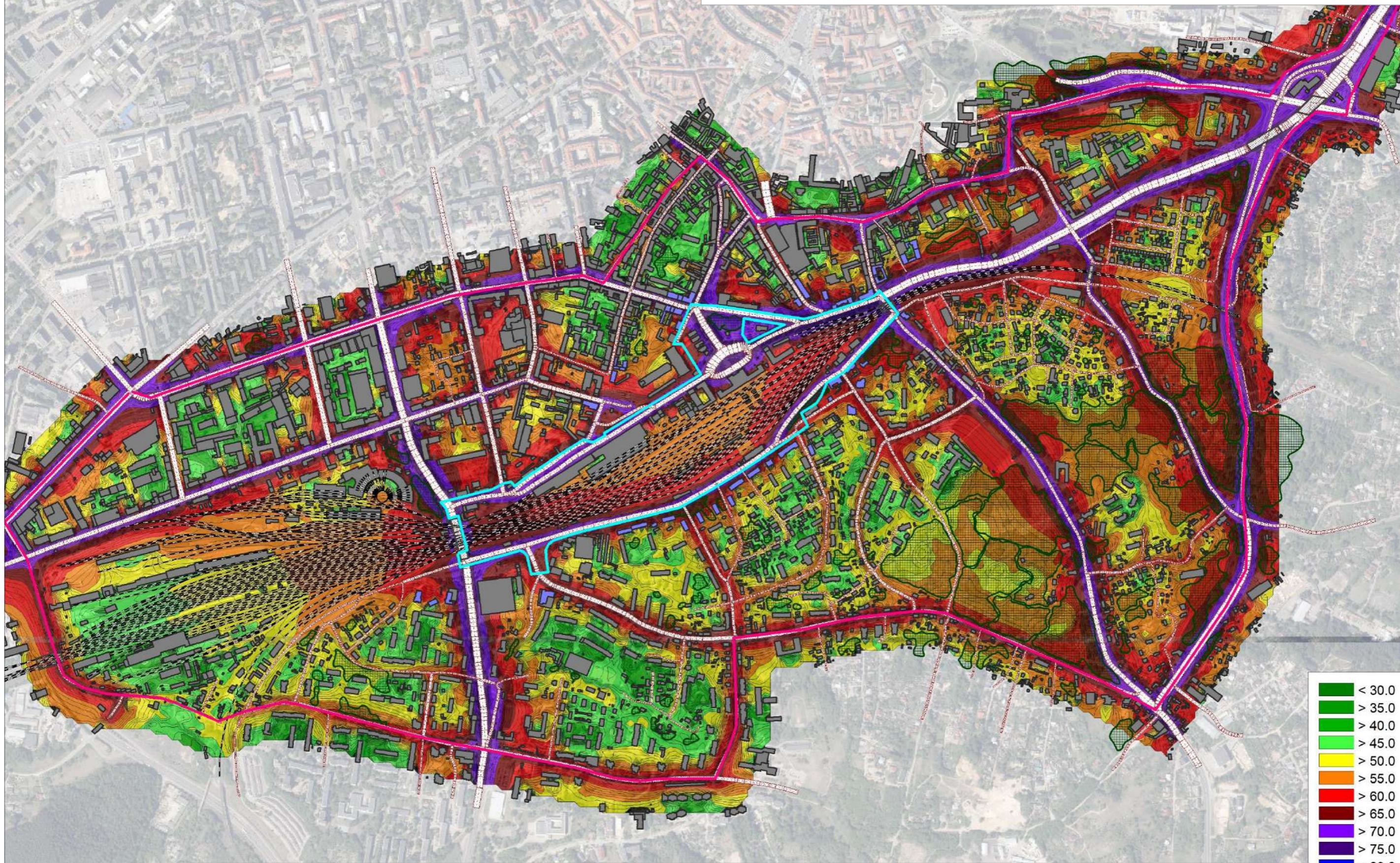
Autotransporto triukšmo sklaida: esama situacija L_{dvn} ekvivalentinis triukšmo lygis dB(A) Triukšmo sklaidos skaičiavimo aukštis – 4,0 m, mastelis – 1:10000, žingsnio dydis – dx(m): 15; dy(m): 15
