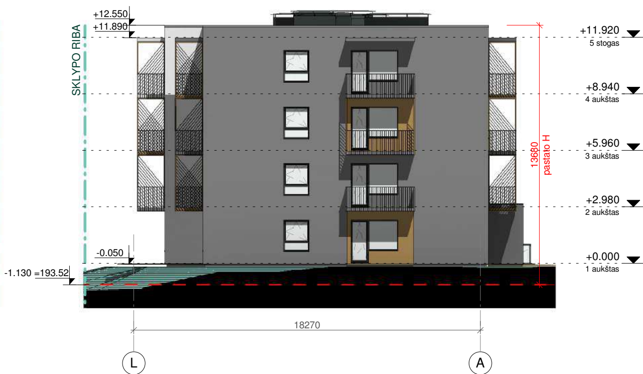
FASADAS TARP AŠIŲ L-A 1 : 200
