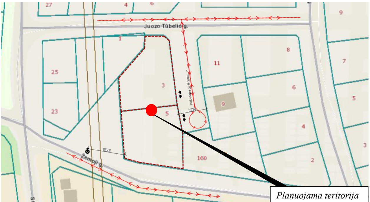
6 pav. Situacijos schema nuo planuojamų sklypų iki hidranto ir gaisrinių automobilių judėjimo trajektorija
