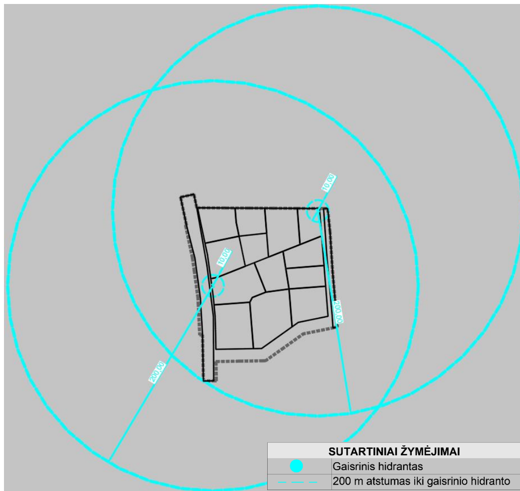
15 pav. Gaisro gesinimo schema
