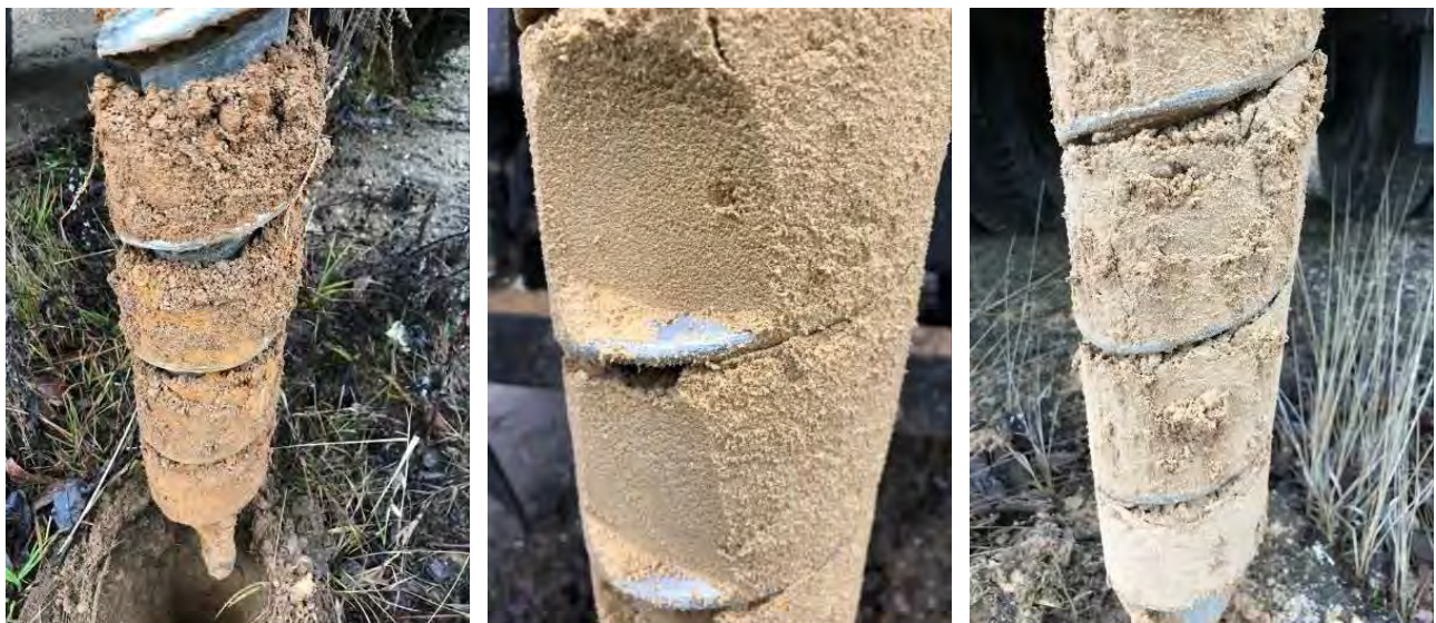
3 pav. Iš kairės į dešinę: piltinis gruntas (tIV); smulkus smėlis su vidutinio priemaiša (ftIImd); dulquis molingas (ftIImd).
