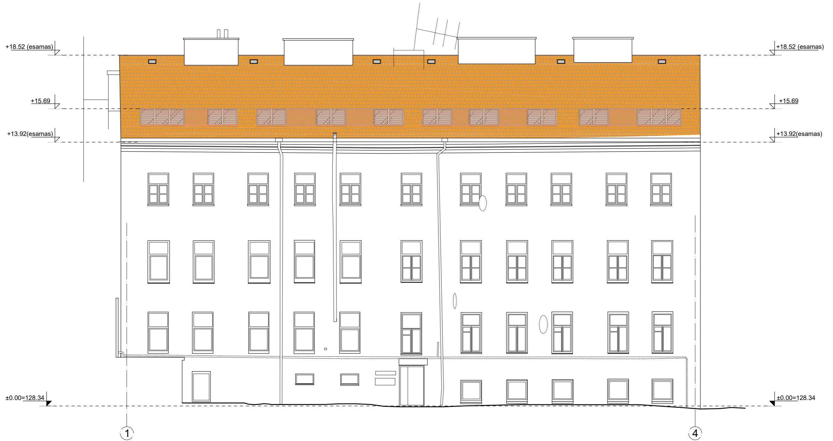
Fasadas tarp aių 1-4, M 1:125
