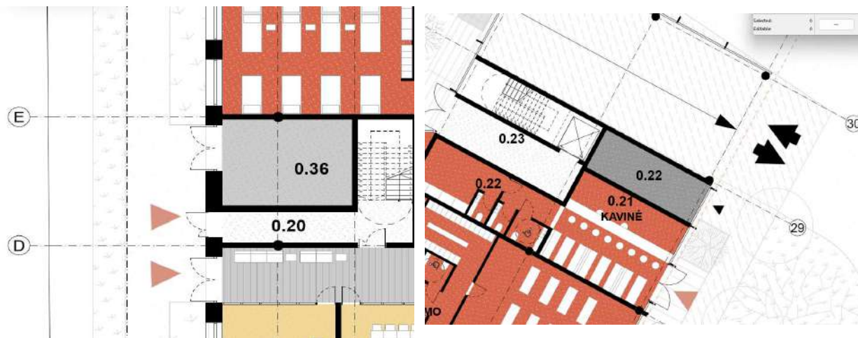
Pav. 27_Buitinių atliekų rūšiavimo vietas pastate patalpose 0.36 ir 0.22
