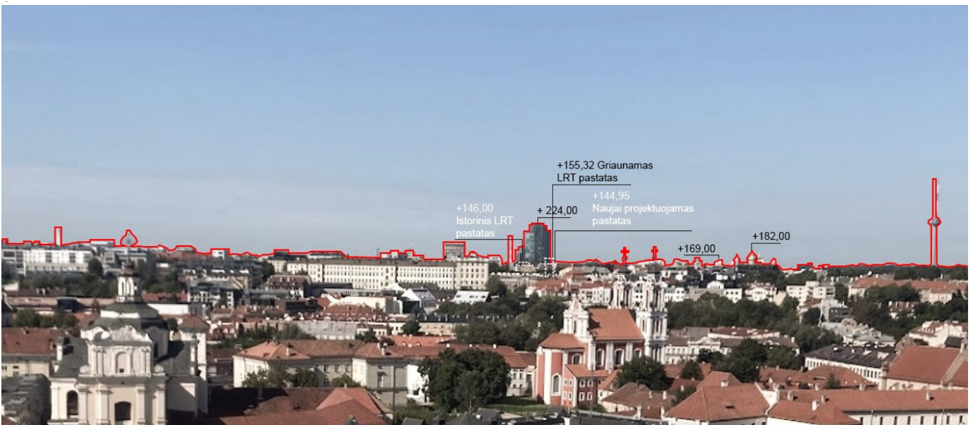
16 pav. Vilniaus senamiesčio vertingosios savybės - Senamiesčio panoramos nuo Šv. Jonų bažnyčios varpinės ištrauka su charakteringomis užstatymo altitudėmis. Projektuojamo pastato korpusai panoramos siluete nematomi. Juos didžiaja dalimi užstoja Helios pastatas.
