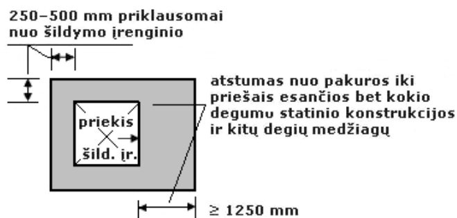
Pav. 6. Atstumo tarp šildymo įrenginio ir statinio konstrukcijos ir kitų degių medžiagų nustatymo principas
