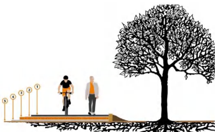
vo dig METODO PRINCIPU APSAUGOMAS MEDIS ĮRENGIANT PAKELTAS KIETAS DANGAS MEDŽIO ŠAKNŲ APSAUGOS ZONOJE
