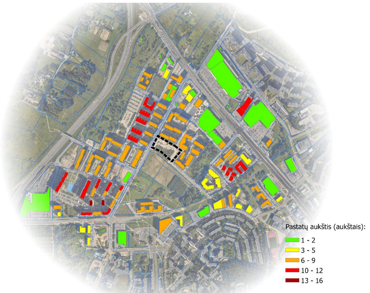
Pav. 1. Esamų pastatų aukščio schema
