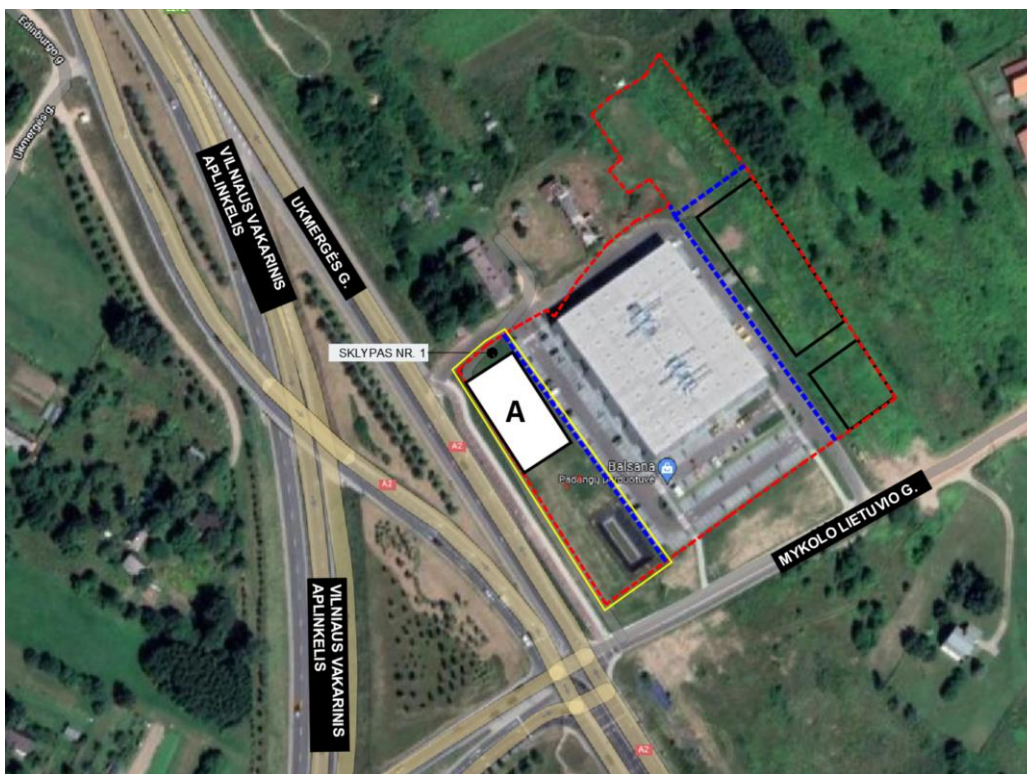
Statybos vieta. Esama situacija. Sklypų ribos po detaliojo plano pakeitimų pažymėtos mėlynai. Teritorija apimanti projekto sprendinius pažymėta geltonai
