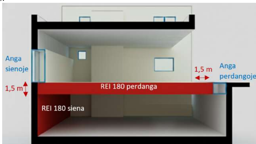
1 Pav. Pastato pjūvis su vertikalaus ugnies plitimo ribojimo reikalavimai
