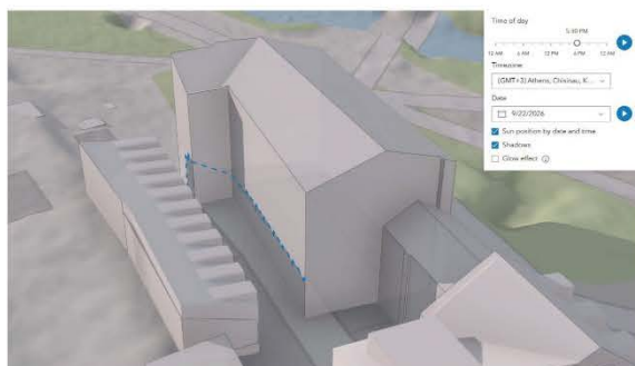
Pav. 15 Rekonstruojamo pastato tūrio įtakos aplinkinių pastatų patalpų apšvietimui schema
