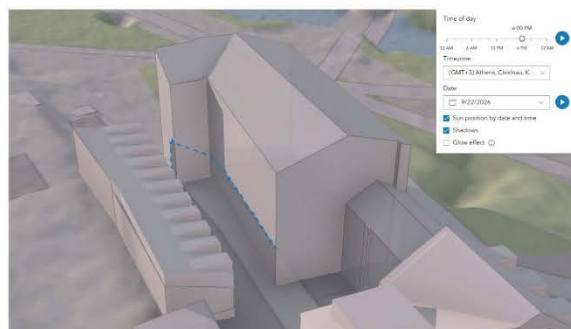
Pav. 15 Rekonstruojamo pastato tūrio įtakos aplinkinių pastatų patalpų apšvietimui schema
