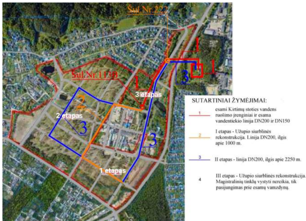
31 pav. Vandentiekio inžinerinės infrastruktūros įrengimo etapai su 2 alternatyva.
