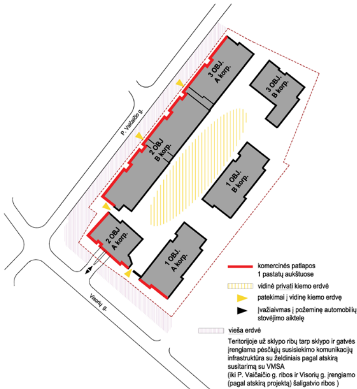
9 pav. Užstatymo schema su vešiosiomis ir privačių erdvių išdėstymu
