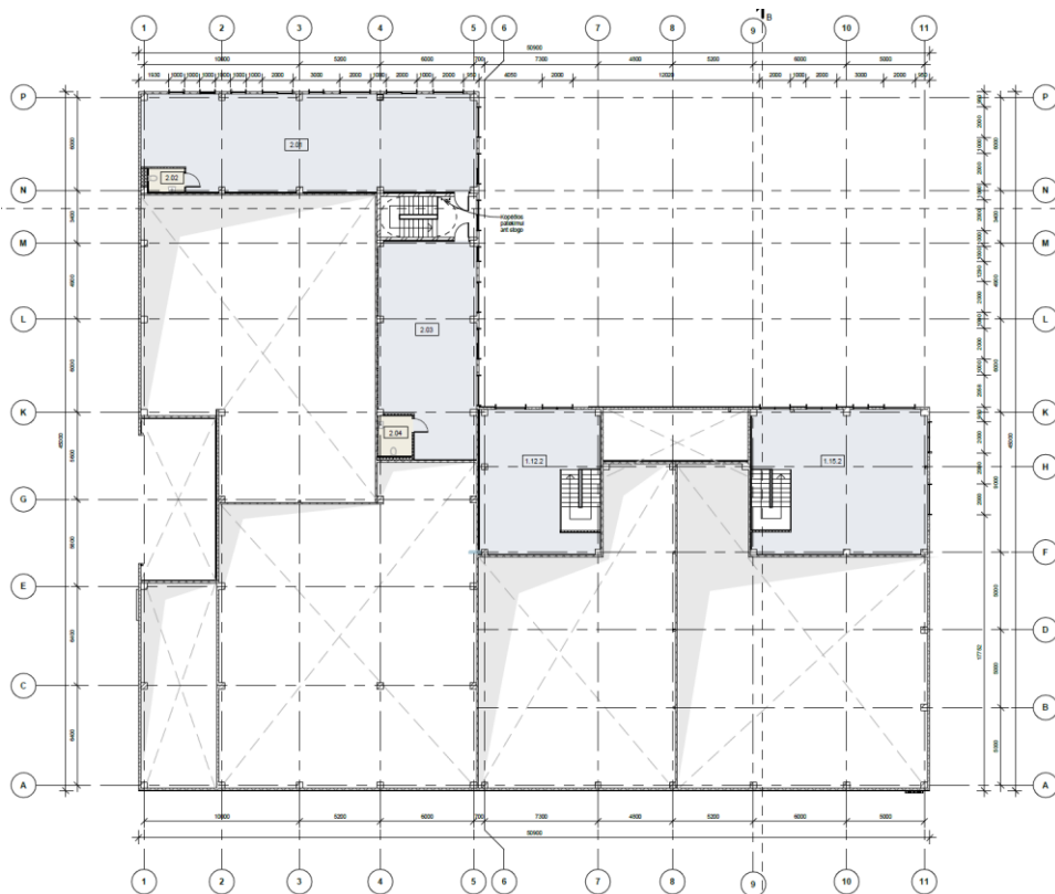
7 pav. Sandėliavimo paskirties pastato antro aukšto planas.
