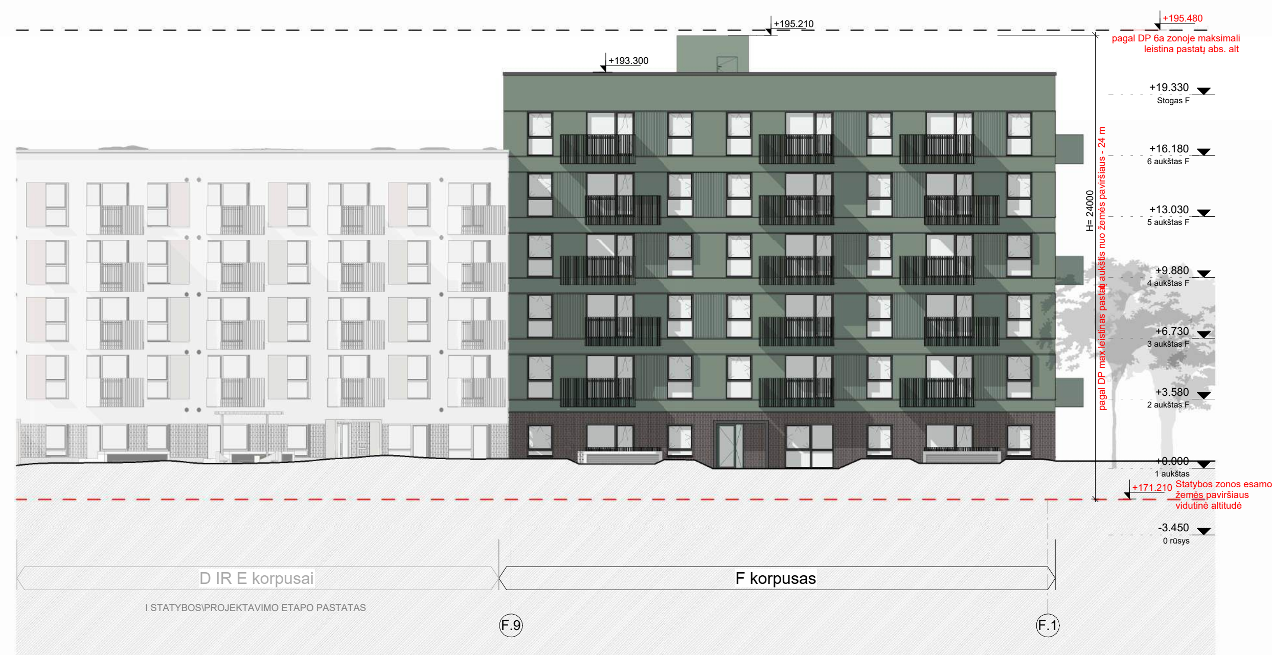
2. FASADAS TARP AŠIŲ F.9 - F.1 (Kiemo fasadas) 1:200
