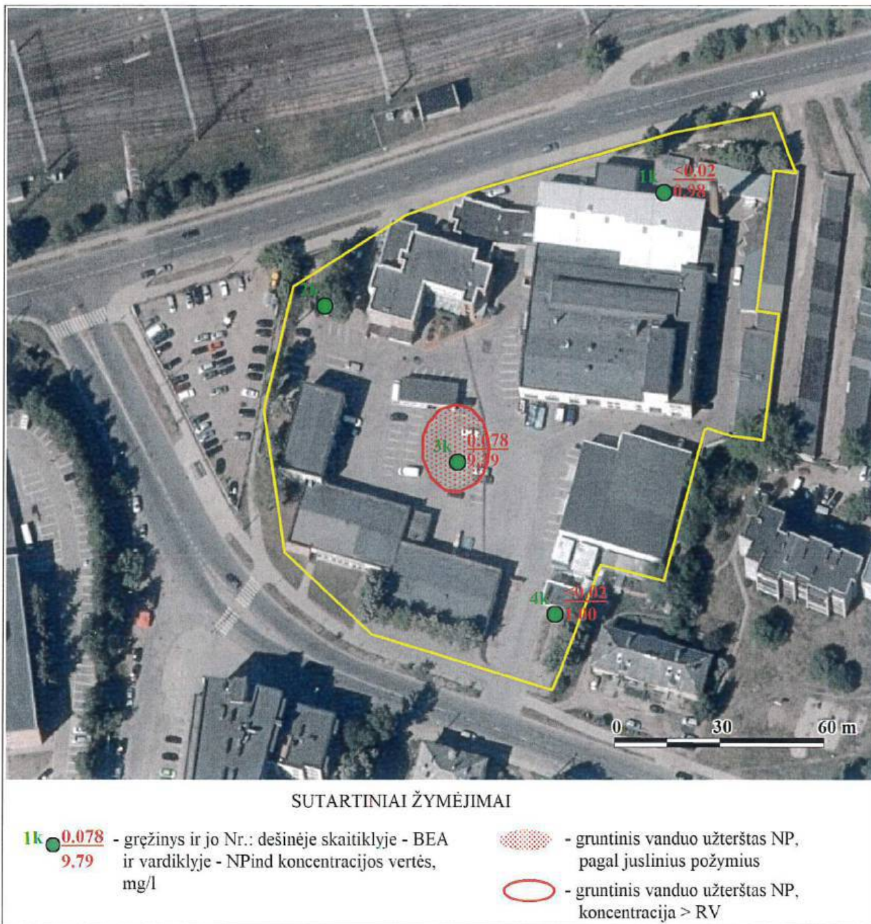
7 pav. Grūntinio vandens užterštumo naftos angliavandeniliais schema
